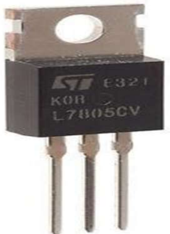
3.1 – сурет - L7805CV сызықты кернеу реттегіші
